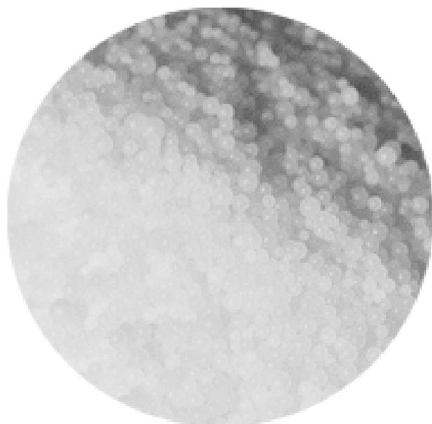
Полиэтиленовый воск неокисленный, неполярный, высокой вязкости.
